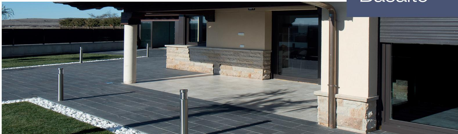
**BASALTO** es un gres natural extrusionado respetuoso con el medio ambiente. El Gres de Breda exige un equilibrio óptimo entre la temperatura máxima de cocción (1.360° C), la estabilidad de la masa y las distintas atmósferas del horno. Esta armonía es fundamental para conseguir sus altas prestaciones técnicas: extrema dureza, gran resistencia a las temperaturas bajas (- 45 ° C), choques térmicos y resistencia al deslizamiento.
