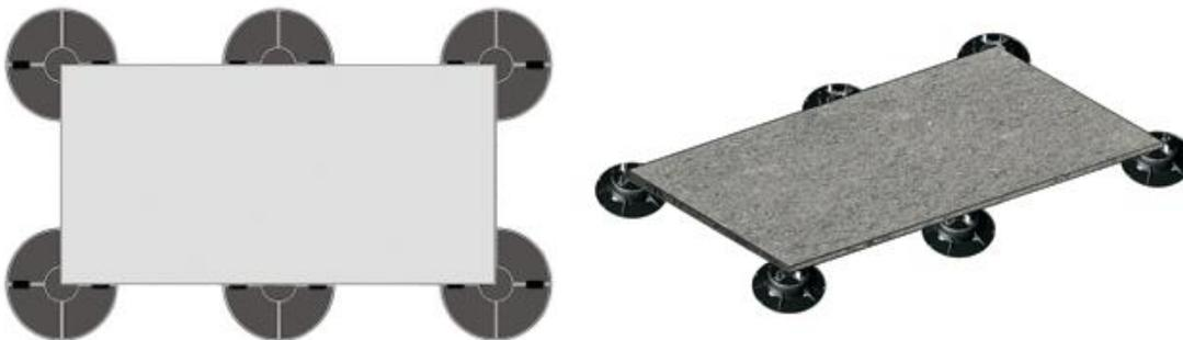
Si se requiere una altura superior, Florim recomienda encolar una lámina o una red de seguridad en la parte posterior, y utilizar soportes adicionales debajo de la losa, tal como se muestra en el esquema adjunto.
