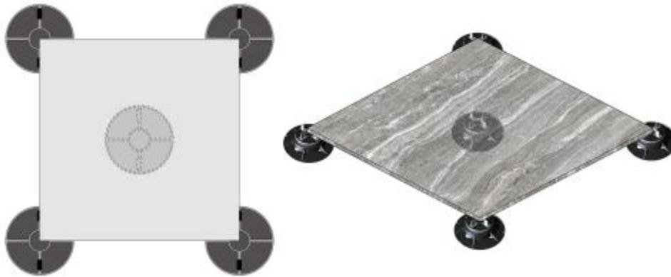
**FORMATO 40 x 80 un soporte en cada vértice + un soporte central (en conjunto, dos soportes por losa)**
