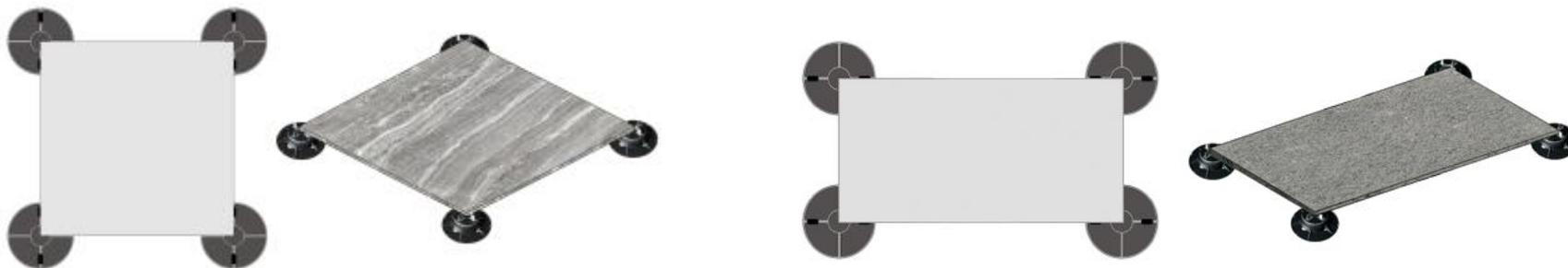
En caso de pavimentos de uso público o en presencia de cargas elevadas, Florim recomienda la utilización de soportes adicionales debajo de la losa, tal como se muestra en el esquema adjunto.
