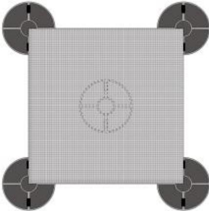
**FORMATO 40 x 80: un soporte en cada vértice + un soporte central (en conjunto, dos soportes por losa)**
